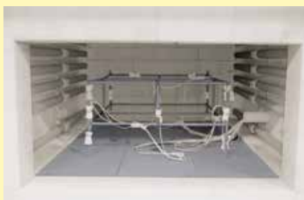
Измерительное устройство в печи для отжига
