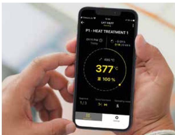
Индикация хода выполнения программы для каждой печи
