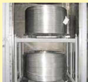
Передача тепла от теплой партии изделий холодной партии
