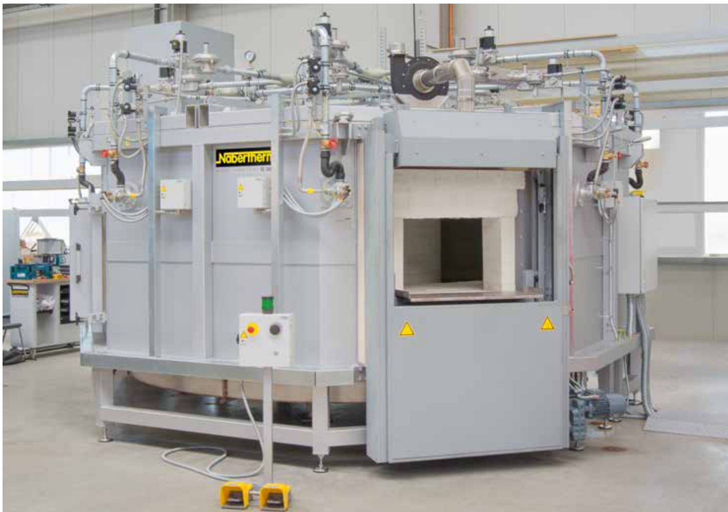
Печь с вращающимся подом с прямым газовым обогревом с Tmax 1100 °C для предварительного подогрева форм
