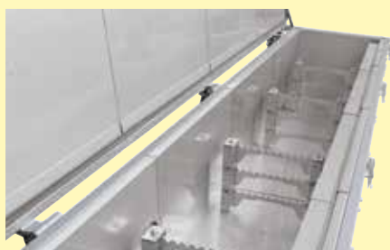
Подставка для посадки длинных труб в печь с верхней загрузкой и циркуляцией воздуха SAL 750/08
