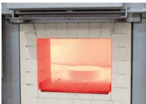
Предварительный нагрев стальных колец дляковки в печи с вращающимся подом
