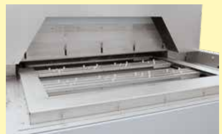
Проходная печь D 1000/1250/200/26AS для закалки деталей из сплавов, полученных методом литья под давлением
