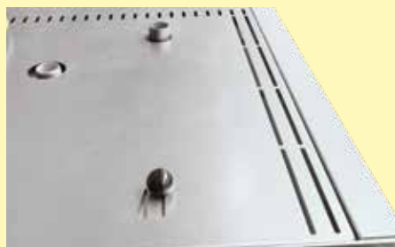
Закрывающееся отверстие для отвода воздуха на своде печи
