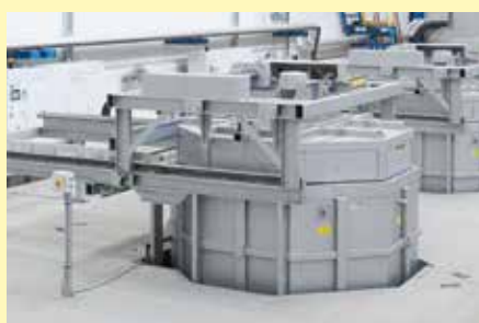
Шахтная печь с циркуляцией воздуха S 10400/75 AS в производстве
