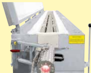
Протяжные печи для отжига проволоки на основе трубчатой печи длиной 6 м
