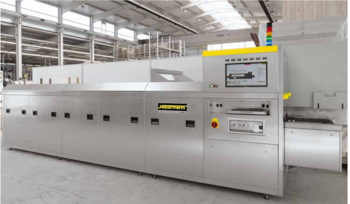
Прходная печь DF 36/320/5/10WK для выжигания и обжига/спекания в LTCC-производстве
