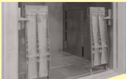
Загрузочная платформа у печей с изоляцией пола для процессов, при которых предъявляются высокие требования к однородности температуры
