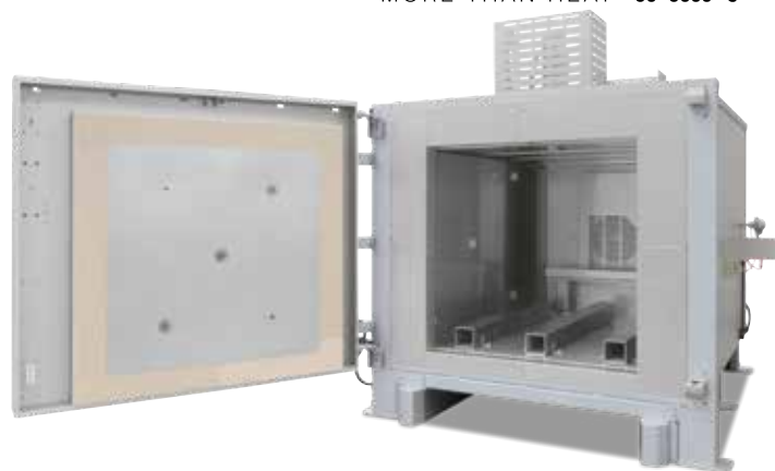
Камерная печь с циркуляцией воздуха NA 1500/45 на основании с направляющими и концевым упором для погрузчика клиента, подставка для загрузки с учетом требований клиента и защитные дуги
