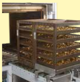
Проходная печь для термообработки клепок
