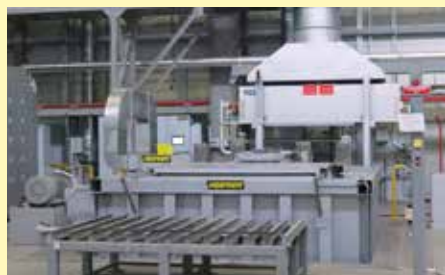
Масляная закалочная ванна OAB 67000 с теплообменником, объем масла 67 000 литров
