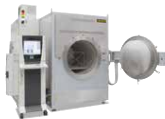
Горячая ретортная печь LH 300/09 для отжига со снятием напряжений с металлических деталей в среде защитного газа или вакуума после 3D-печати
