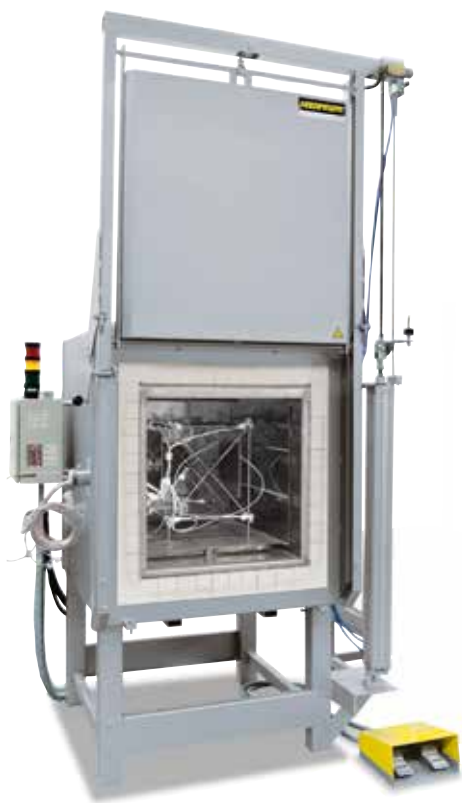
Измерительная рама для определения однородности температуры
