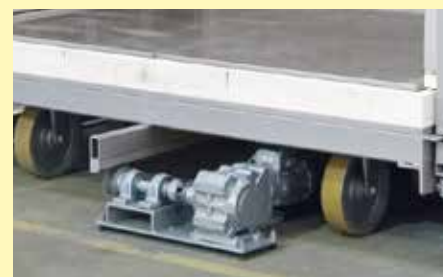
Под на стальных колесах с реечным приводом, не требуется укладка направляющих до печи
