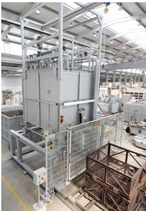
Печь с вертикальной шахтой FS 5670/60AS со встроенной в под закалочной ванной (вариант С)
