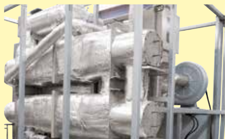
Противоточный теплообменник в камерной печи с циркуляцией воздуха N 2560/26 ACLS
