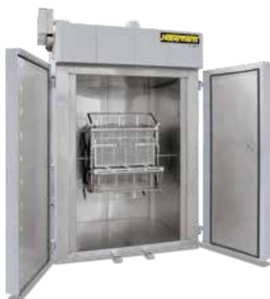
Камерная сушилка KTR 3100 DT с поворотной стойкой
