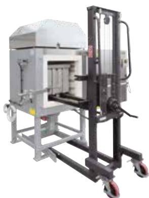
Камерная печь LH 216/12 для отжига со снятием напряжений с металлических деталей в среде защитного газа после 3D-печати
