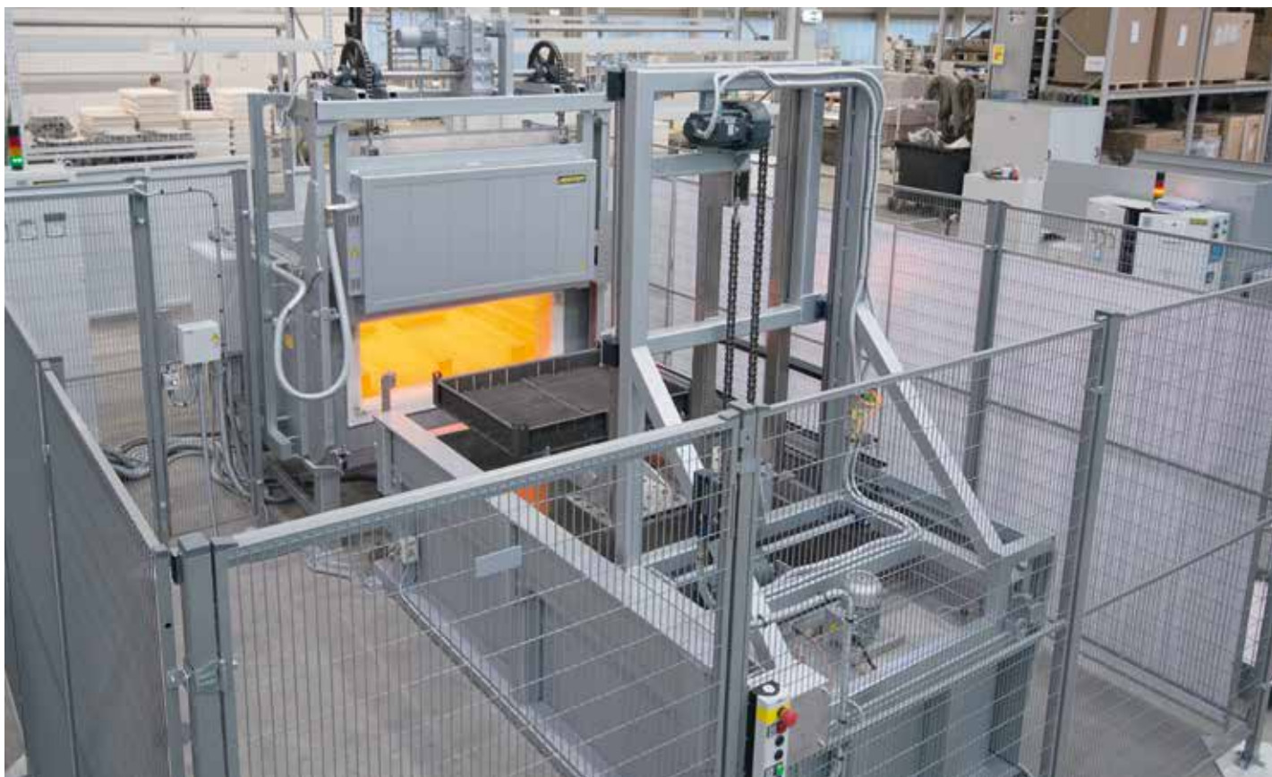
Автоматическая установка для улучшения свойств, состоящая из печи для отжига, водяной закалочной ванны и двухосевого манипулятора
