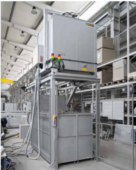
Установка с печью с вертикальной шахтой со стационарной закалочной ванной (вариант А)
