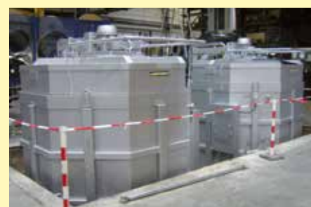
Шахтная печь с циркуляцией воздуха SAH 5600/75 S в производстве
