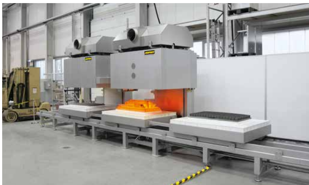
Установка для улучшения свойств с колпаковой печью H 4263/12S и водяной (закалочной) ванной
