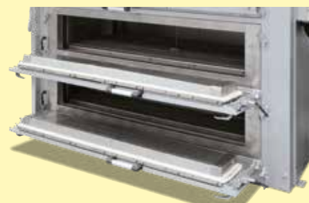
Многокамерная печь NA 4400/26 для различных периодов останова
