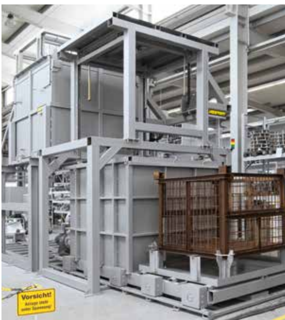
Автоматическая печная установка с вертикальной шахтой с разгрузочным краном (вариант В)
