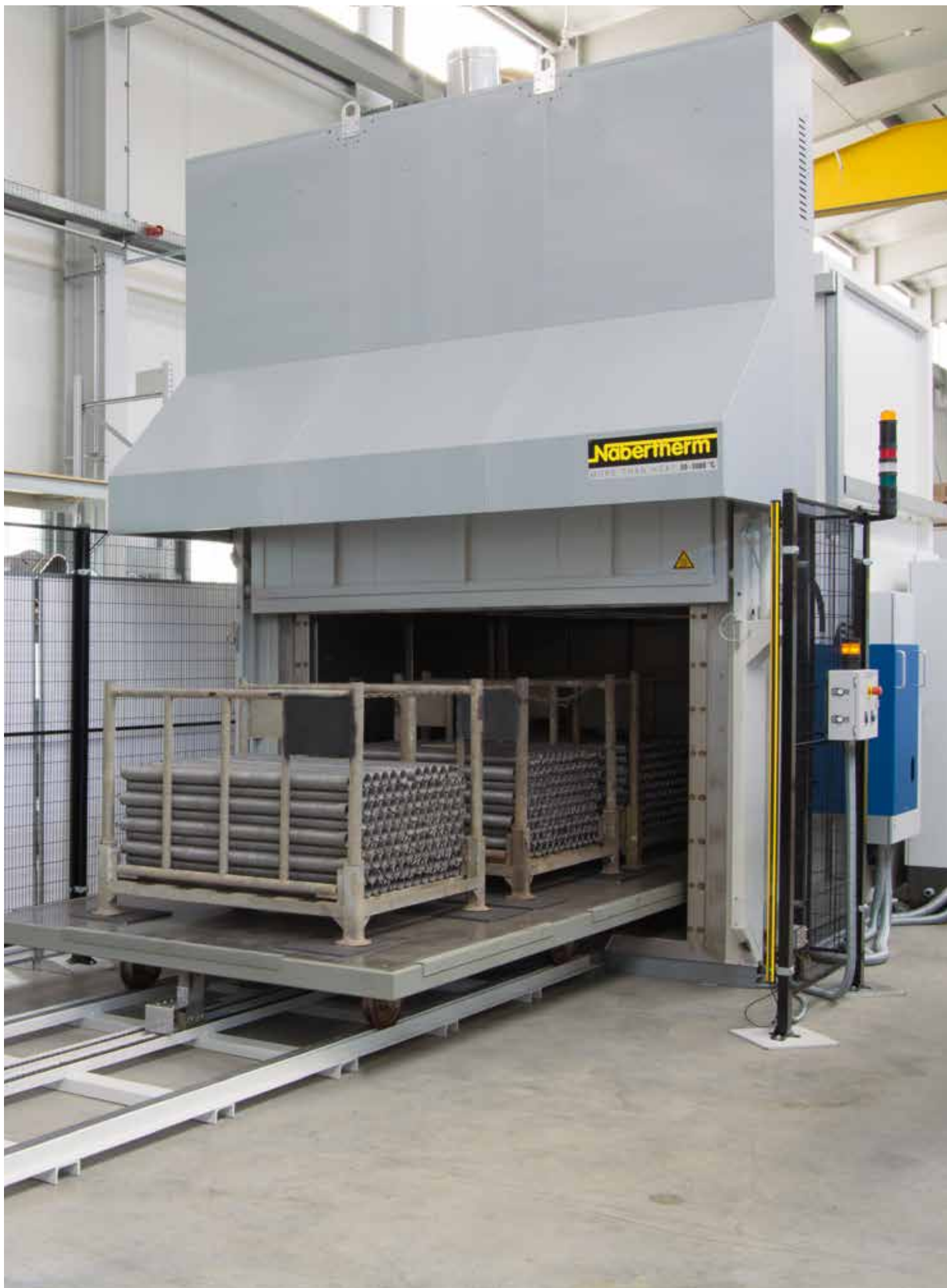
Камерная печь с циркуляцией воздуха и с прямым нагревом газом NB 10080/26NAS, а также с приводной загрузочной тележкой
