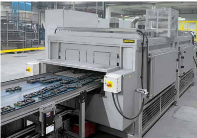
Конвейерная печь D 1000/4000/140/35 AS для сушки шлихты на песчаных стержнях
