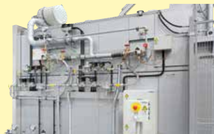
Система горелок для нагреваемой газом печи с циркуляцией воздуха и выдвигаемым подом WB 4000/85 AS
