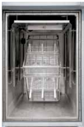
Поворотная тележка с моторным приводом и коробами для перемещения материала во время его тепловой обработки
