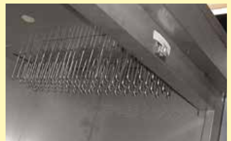
Нагревательный регистр при исполнении с электрическим обогревом с Т макс 450 °С и 600 °С
