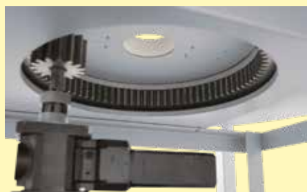
Шестеренчатый привод под печью с вращающимся подом
