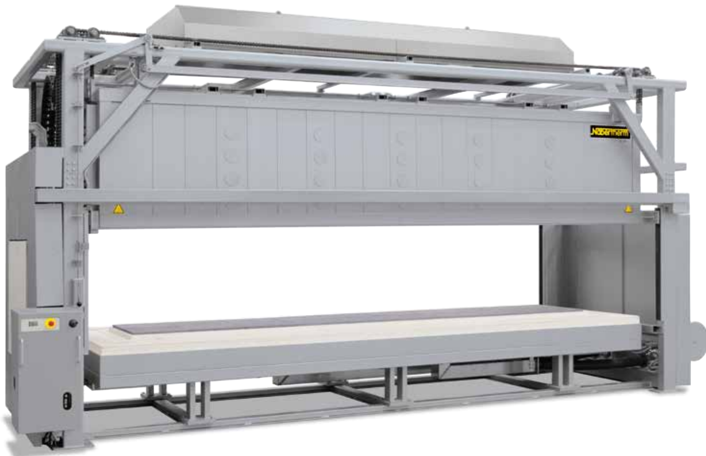
Колпаковые печи H 3070/S для загрузки и разгрузки на передней и задней стенке
