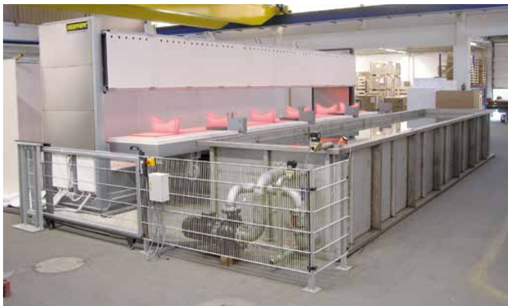
Установка для улучшения свойств с колпаковой печью H 4263/12S и водяной (закалочной) ванной
