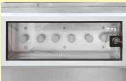
Einstellbare Begasung für gereinigte, trockene Luft (CDA). Abschließbar zur Erhöhung der Prozesssicherheit
