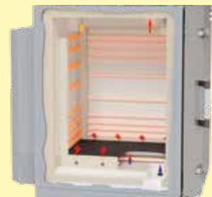
Schematische Darstellung der Luftführung im Kammerofen N(B) .. BO
