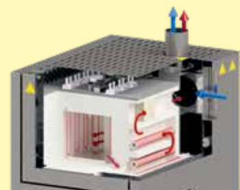
Schematische Darstellung der Luftführung im Kombiofen LHT 08/17 BO
