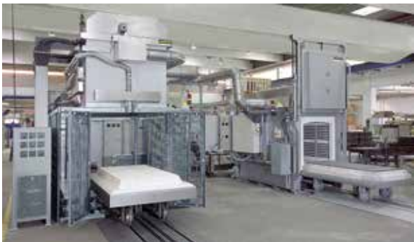
Hochtemperatur-Haubenofen HT 1700/17 LT DB200-5 zum Entbindern und Sintern von keramischen Pulvern
