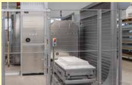
Sicherheitsbereich abgegrenzt durch Rolltore und Schutzzaun
