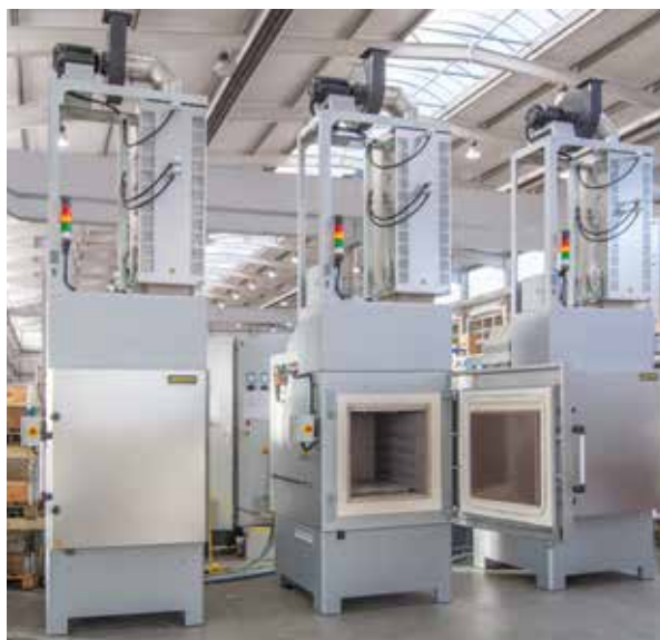
Produktionsanlage mit drei Umluft-Kammeröfen NA 250/85 DB200 zum Entbindern und katalytischer Nachverbrennung KNV 320 (stellflächenreduzierende Bauweise)
