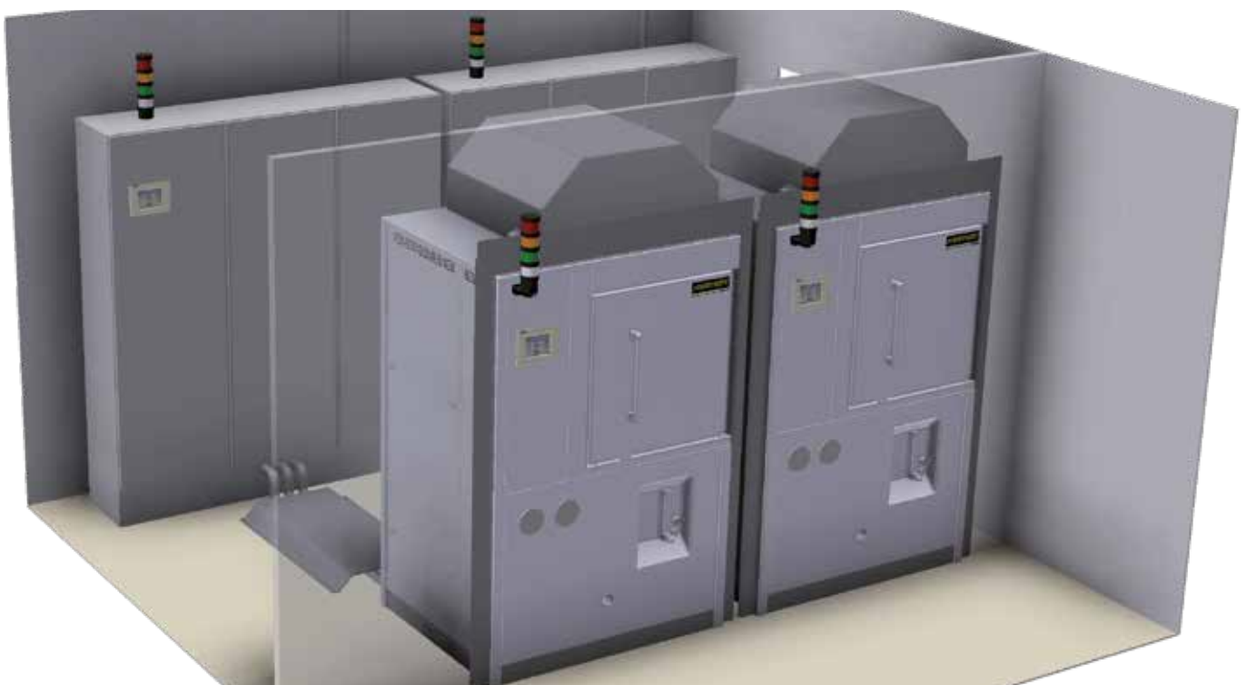
Hochtemperaturofen mit Beladung vom Reinraum; Schaltanlage und Ofen im Grauraum
