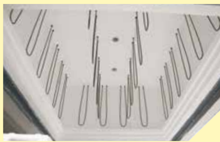
Beheizung von allen Seiten und zwischen dem Stapel zur Optimierung der Temperaturgleichmäßigkeit
