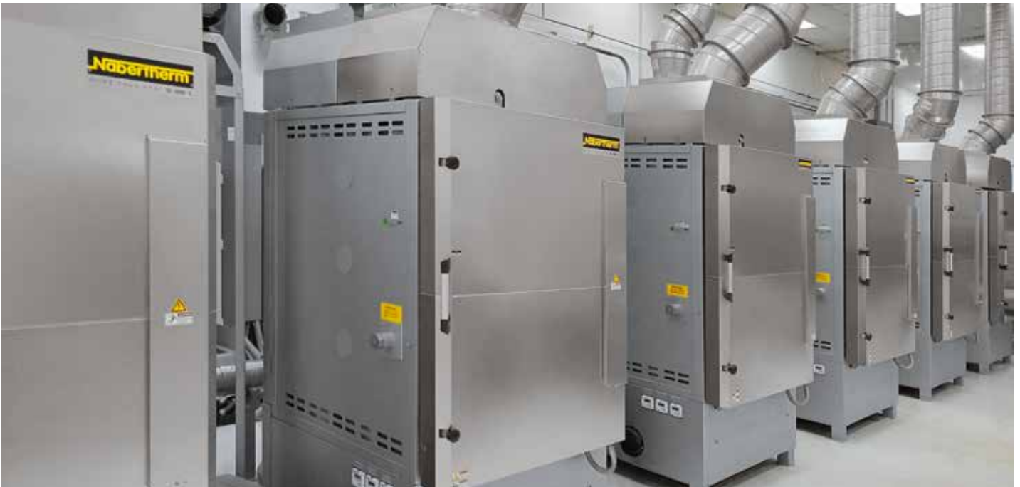
Produktionsanlage bestehend aus Kombi-Kammeröfen N 650 DB200 mit katalytischer Nachverbrennung für alternierenden Betrieb
