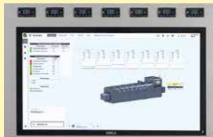
Digitale Anzeige aller Einstellwerte über NCC (u.a. Temperaturüberwachung je Heizzone, Begasungsmengen)
