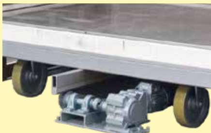
Wagen auf Stahlrädern ohne Schienenverlegung mit Zahnstangenantrieb
