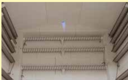
Ofenraum N 300 BO mit gasbetriebener Zündflamme und elektrischer Ofenheizung
