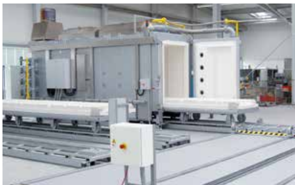
Gasbeheizter Herdwagenofen WB 6200/12 BO zum Ausbrennen von keramischen Isoliermaterialien
