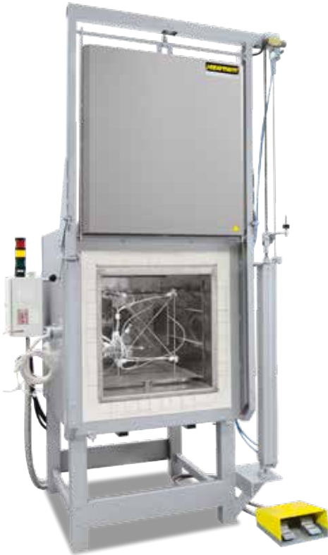
Messgestell zur Ermittlung der Temperaturgleichmäßigkeit
