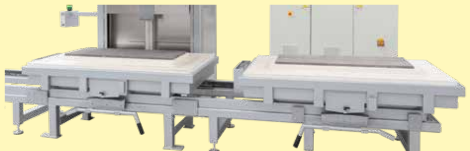
Manuelles Wechseltischsystem für zwei Tische zum zyklusparallelem Be- und Entladen der Charge
