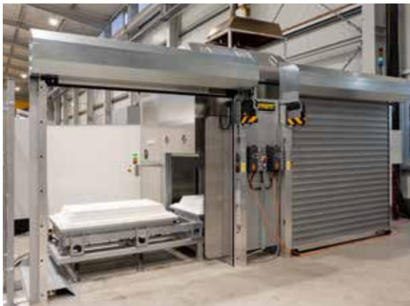
Hochtemperatur-Haubenofen HT 400/17 LT DB200-4 mit Rolltoren für den automatischen Tischwechsel
