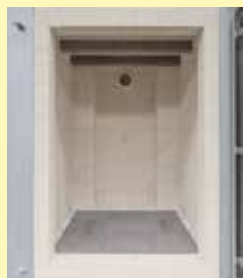
Ofenraum NB 650 BO mit gasbetriebener Ofenheizung
