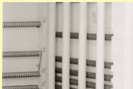
Einblasung vorgewärmter Luft über perforierte Keramikrohre
