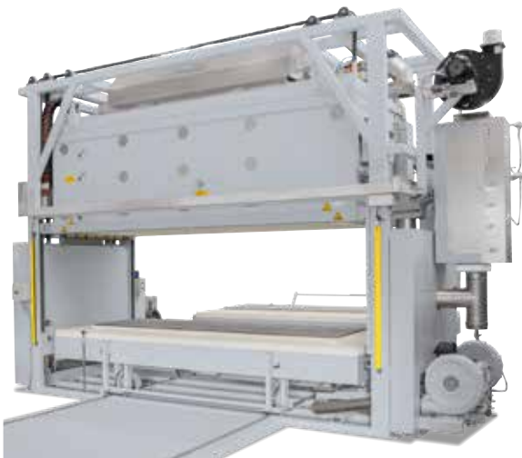
Haubenofen H 3000 DB200-3 mit Wechseltischsystem für zwei Tische und am Gehäuse installierter katalytischer Nachverbrennung KNV 320
