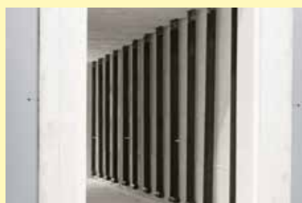
SiC-Heizelemente an beiden Längsseiten des Herdwagenofens
