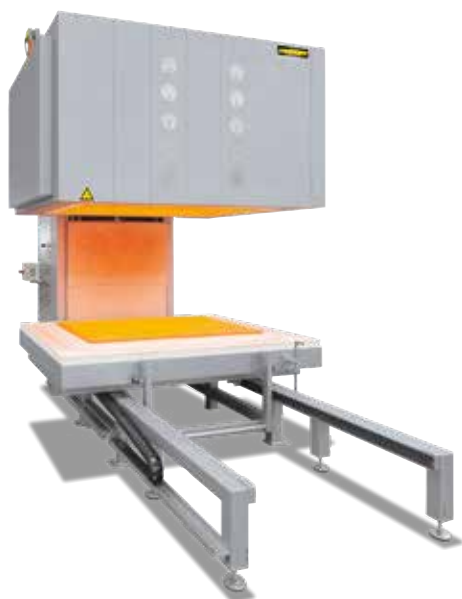
Hubbodenofen H 1600/S für die Wärmebehandlung von Quarzglas. Der Ofen ist für eine Öffnung bei 1000 °C ausgelegt. Der Tisch kann für die Bearbeitung der Bauteile herausgezogen werden.
