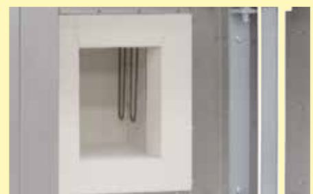
Feuerleichtsteinisolierung und Molybdän-Disilizid-Heizelemente
