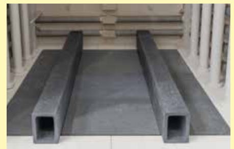
SIC-Chargenauflage zur erleichterten Be-/Entladung mittels Hubstapler
