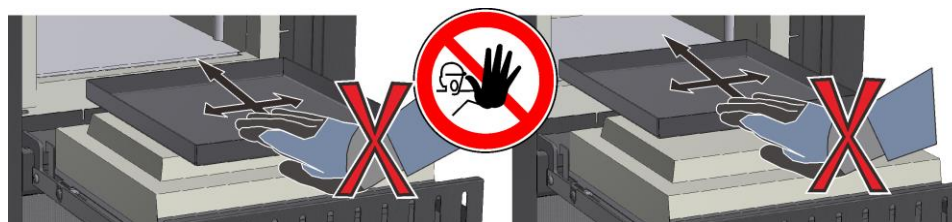
Sl. 36: Primjer: Izbjegavajte oštećivanje izolacije vrata (slično kao na slici)
