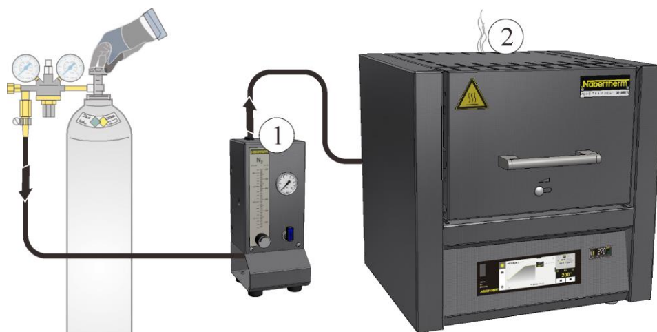
Sl. 50: priključak na sustav za dovođenje plina (slično kao na slici)
