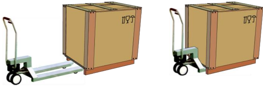
Kuva 14: Nostovaunu työnnetään täysin kuljetustelineen alle
