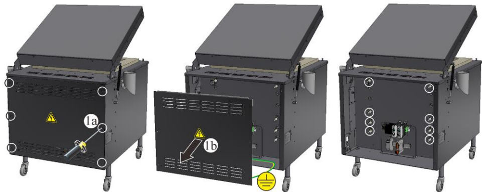
图示75：将开关设备盖板从窑炉背侧卸下（和图示类似）
