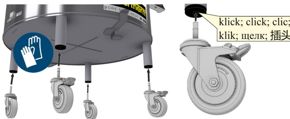
Att. 15: transportēšanas riteņu montāža (skatīt attēlu)
